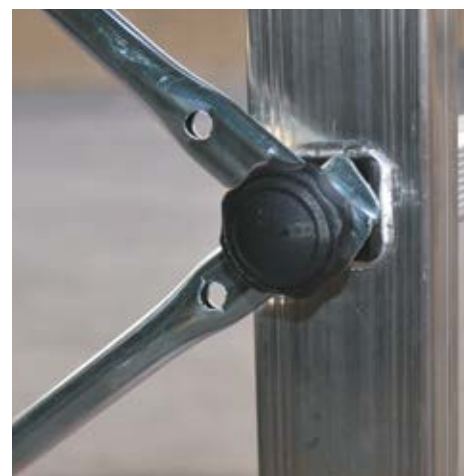
Aste di connessione con pomi di sicurezza. Connecting bars with safety knob
